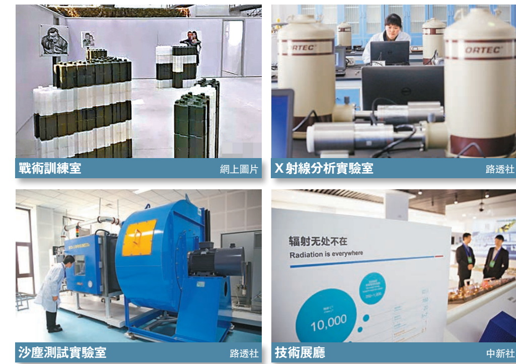
此外，這裡還有各種模擬核材料運輸中的安全測試，例如360度環繞噴水測試防水功能，模擬沙塵暴侵蝕觀察設備是否會失效，還有紫外線、電磁、高溫等條件下保護核材料安全。針對中國大多數核電站建在沿海的情況，還增加了“鹽霧”環境下核設施的抗腐蝕能力測試。
