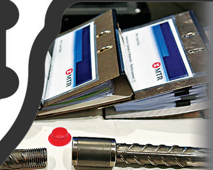
■圖為垂直連續牆及月台板塊間連接需要用到的螺絲帽。 資料圖片
