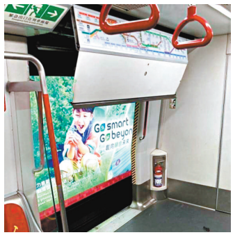
●據乘客在網上貼出的圖片顯示，車廂近車頭左側的兩扇門甩落。網上圖片
