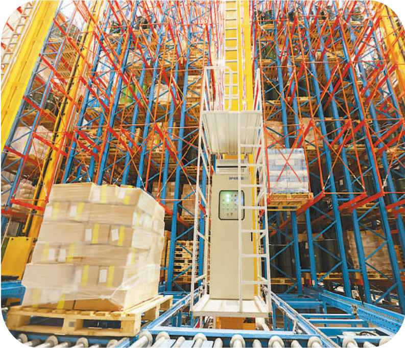
▲江西赣锋锂业股份有限公司 依托云计算、AGV、大数据等先进制造技术，建设智能化仓储系统。图为不久前，万吨锂盐工厂智能立体仓库中，工业搬运机器人自动搬运物料。 凌厚祥摄（人民视觉）
